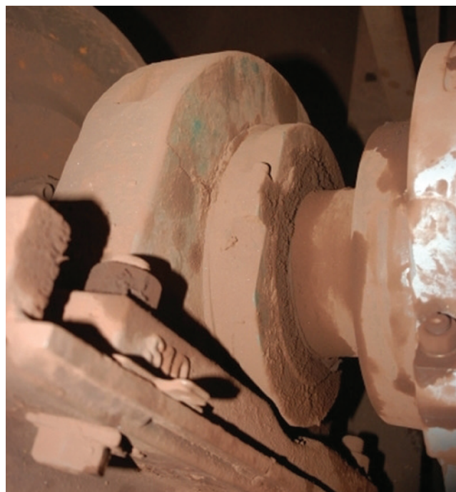
Figure 20. Palier à roulement à rouleaux cylindriques en deux parties Timken illustré dans une application sidérurgique.
